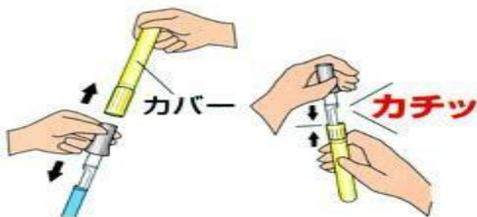
③ 尿を採取後、黄色カバーを抜き取り、元の位置に戻します。戻すときは、カチッと音がするまでしっかり奥まで差し込んでください。
